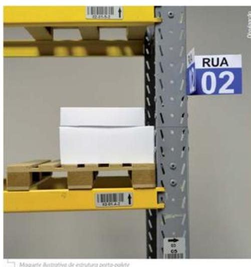
Figura 2: Endereçamento de ruas dentro de um armazém.
