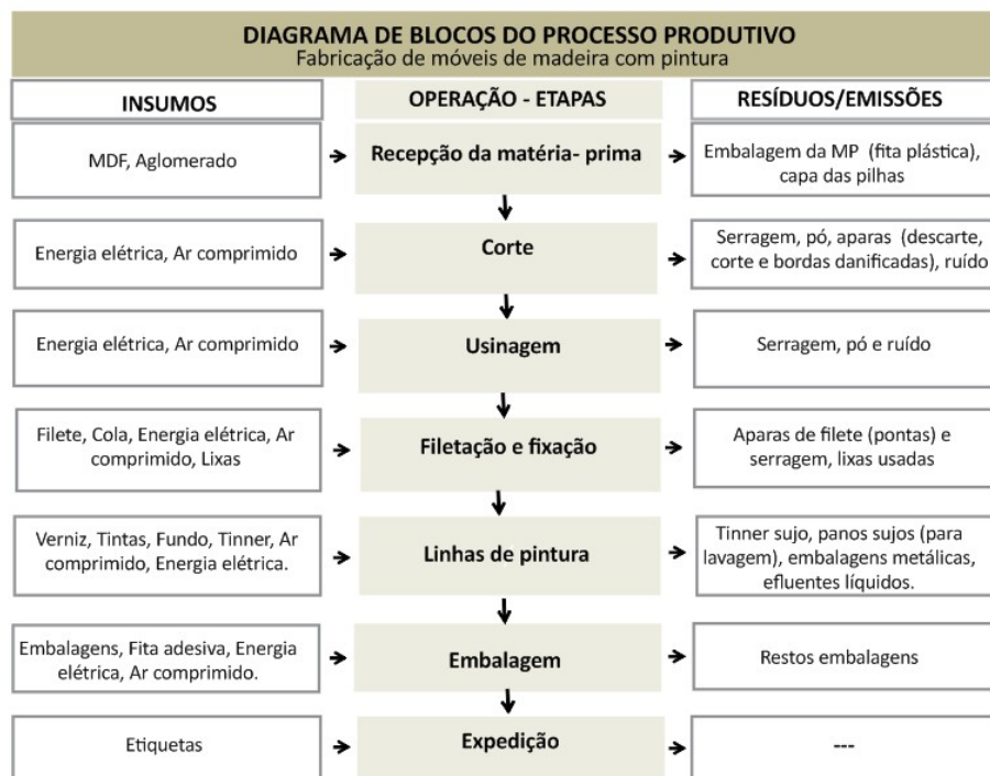
Figura 3 – Diagrama dos blocos de processos produtivos identificados na fabricação do mobiliário. Fonte: Elaborada pelo autor.
