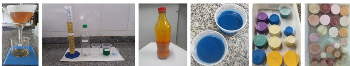
Figura 1: Confecção do sabão a partir do óleo de cozinha usado realizado no Laboratório de Química da Universidade do Estado de Minas Gerais, Unidade de Ubá.
