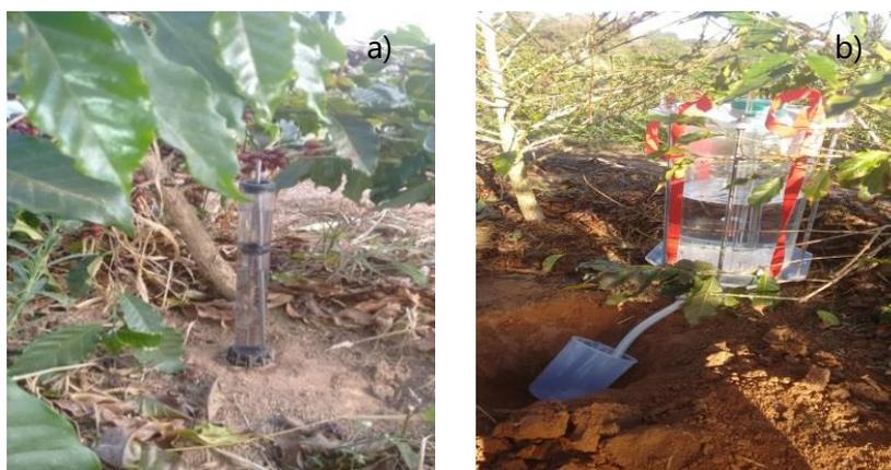
Figura 2. Ensaio com o infiltrômetro de mini disco (a) e infiltrômetro de Cornell (b) em campo. Fotos: Autores (2023).
