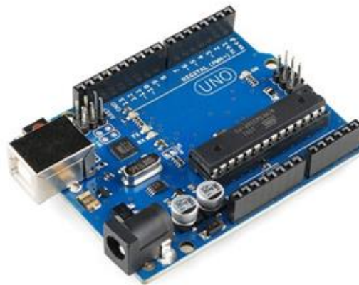
Figura 5: Placa de Arduino do tipo Uno
