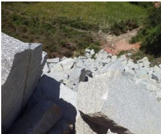
Figura 7: Carreamento de material a jusante da disposição de estéril
