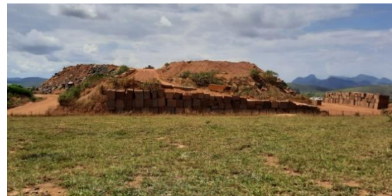
Figura 12: Detalhe da disposição de estéril de RO's em pilhas
