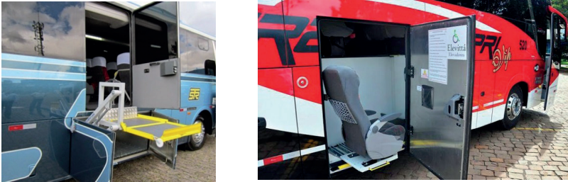
Figura 2 – Modelos de plataforma elevatória em ônibus rodoviário
