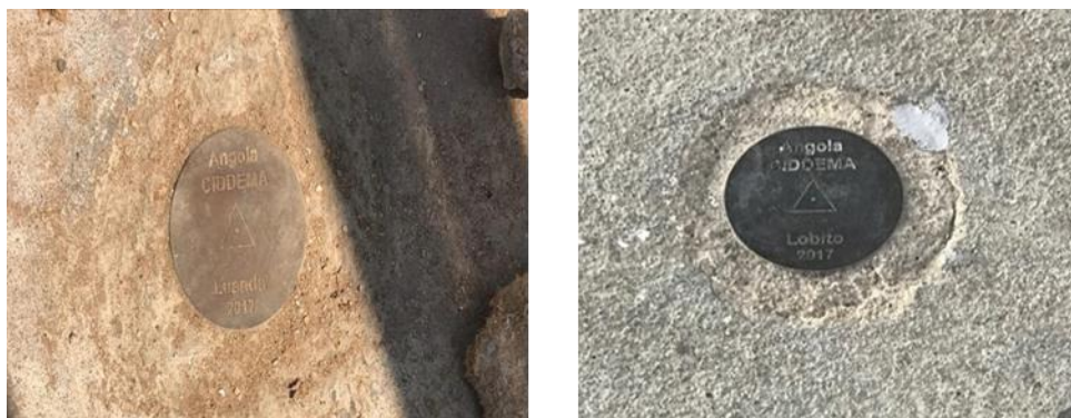
Figura 6. Marca de Nivelamento junto às Estações maregráfica a) de Luanda b) de Benguela
