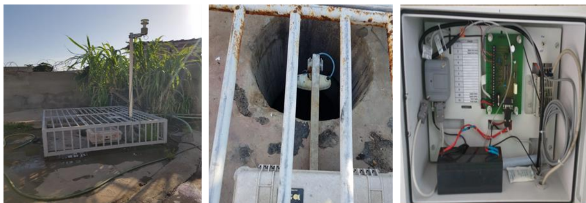
Figura 7 a) Estação maregráfica de Luanda. b) transdutor c) Datalogger aberto
