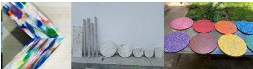
Figura 2: Placas e barras produzidas na Oficina de Transformação de Pedra Furada. Fonte: Autores, 2025.
