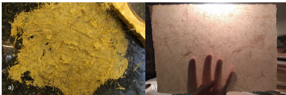
Figura 3a e 3b: a) Fibra processada do bagaço de cana de açúcar; b) Papel da fibra do fuste de bananeira. Fonte: Elaborado pelos autores.
