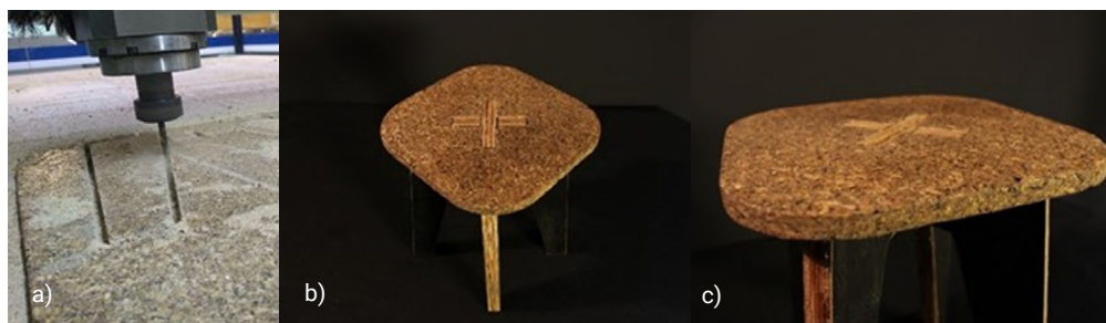
Figura 6a, 6b e 6c: a) Chapa de compósito sendo usinada em router CNC; b) Banqueta com assento em compósito; c) Detalhe do assento em compósito. Fonte: Elaborado pelos autores.
