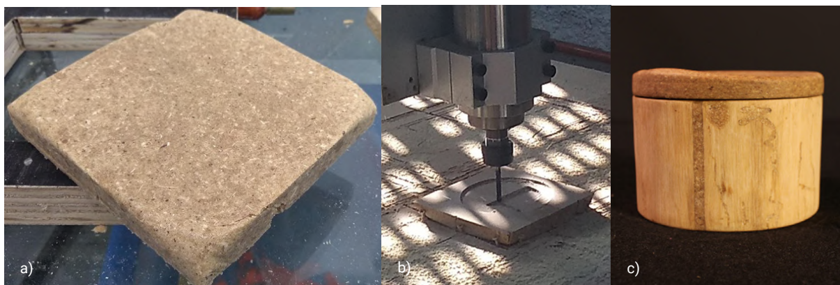
Figura 4a e 4b: a) Compósito desenformado; b) Usinagem da peça; c) Saleiro em madeira e compósito de acrocarpo. Fonte: Elaborado pelos autores.
