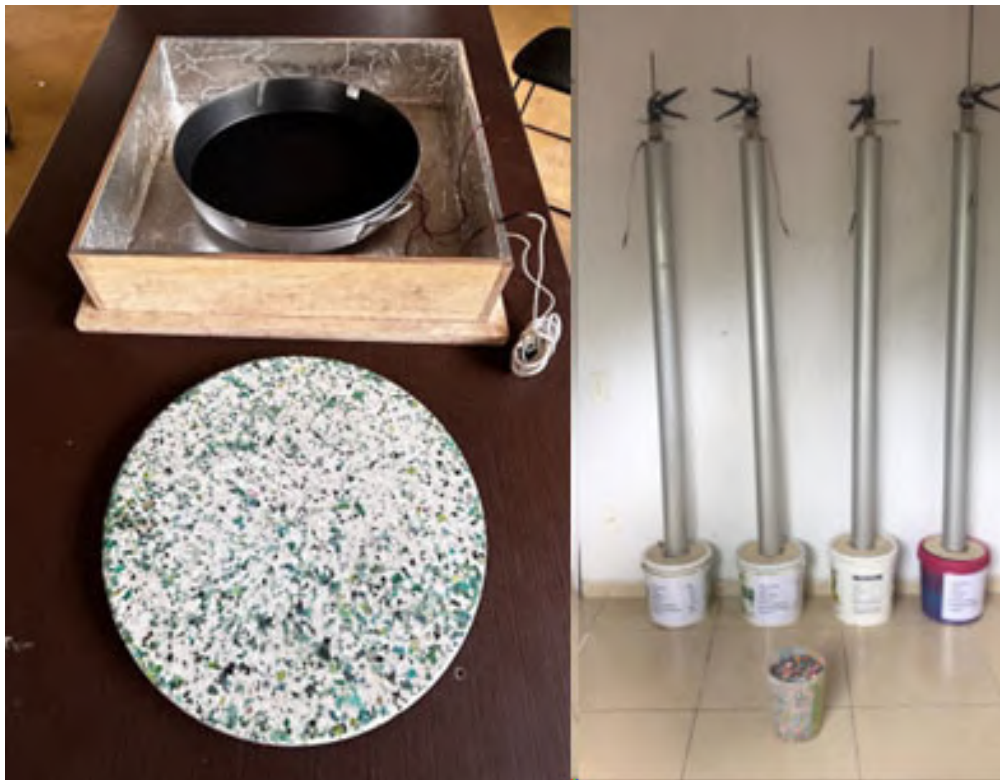
Figura 1: Máquinas de Transformação: à esquerda, máquina para fabricação de placas de plástico e um exemplo de resultado; à direita, 4 (quatro) máquinas para fabricação de barras. Fonte: Autores, 2025.
