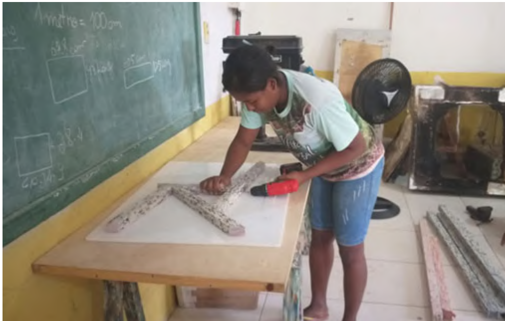
Figura 6: Artesã utilizando gabarito de montagem e parafusando uma lateral de uma cadeira Eco-desk. Fonte: Autores, 2025.
