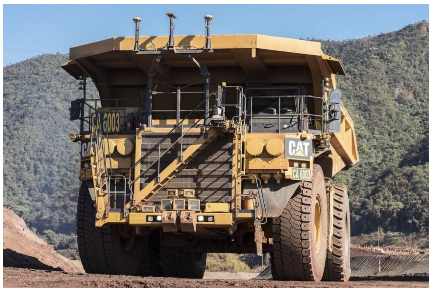
Figura 01: Caminhão fora de estrada autônomo da mina de Brucutu. Fonte: Vale (Jazida, 2023).
