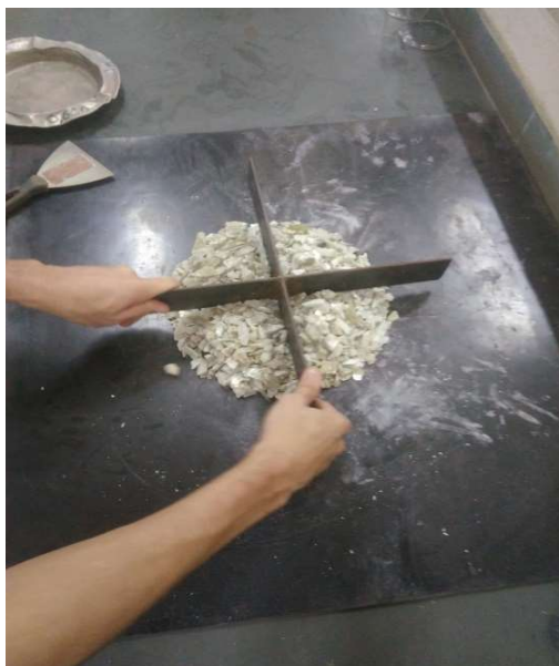
Figura 4 – Homogeneização e quartejamento da amostra de pegmatito litínífero
