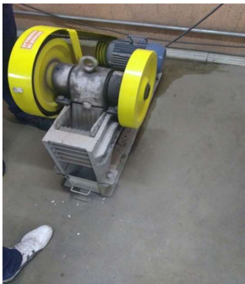
Figura 2 – Amostra do minério sendo britada no britador de mandíbulas
