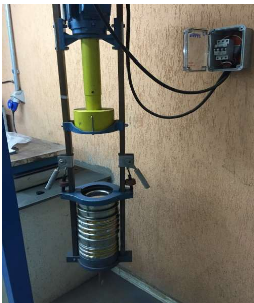
Figura 5 – Peneiramento a seco da amostra de pegmatito litínífero
