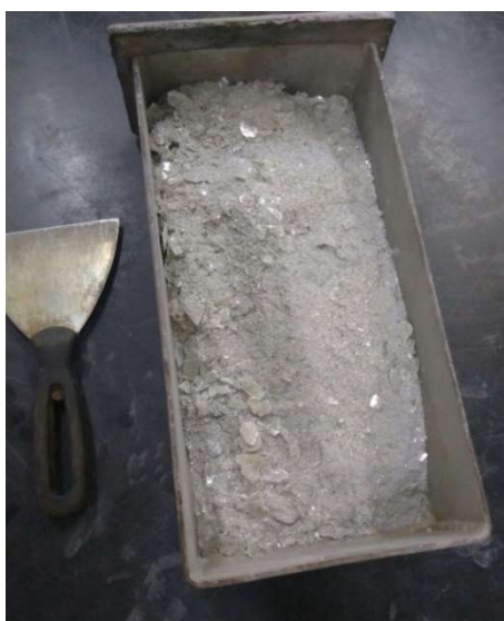
Figura 7 – Amostra de pegmatito litinífero após a moagem
