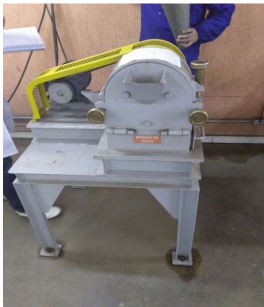
Figura 3 – Amostra pegmatito litínífero sendo cominuida no Moinho de Disco modelo MD200
