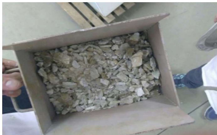
Figura 6 – Amostra de pegmatito litinífero após a britagem
