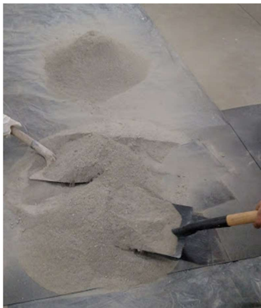
Figura 1 – Homogeneização da amostra de rejeito esmeraldífero
