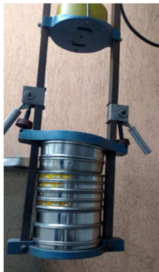
Figura 3 – Peneirador vibratório suspenso para determinação da análise granulométrica do rejeito esmeraldífero
