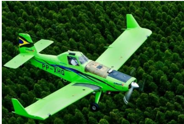
Figura 5 – Avião agrícola modelo Ipanema movido a etanol. Fonte: EMBRAER (2014).
