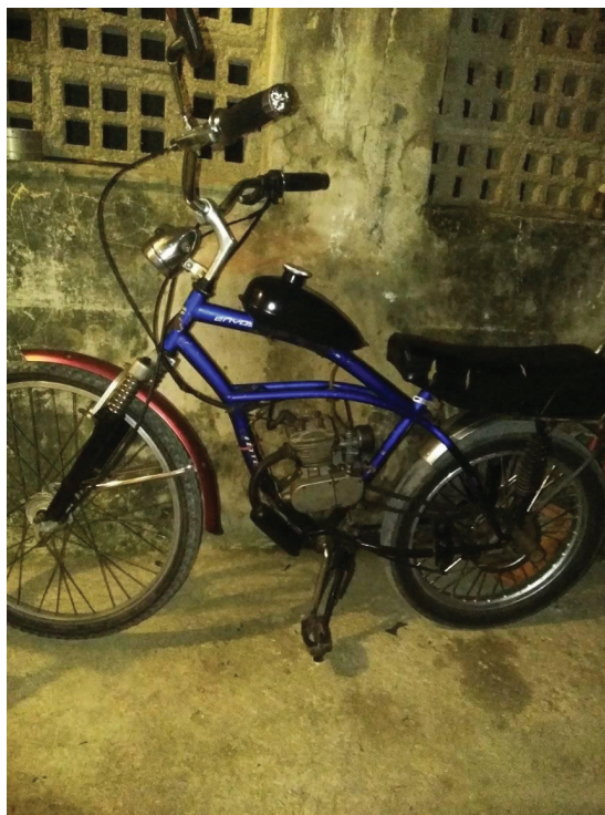
Figura 2: Um veículo que inicialmente era uma bicicleta tradicional, com a adição de um motor. Fonte: https://www.technologicaldisobedience.com/2021/07/26/rikimbilis-2021 .
