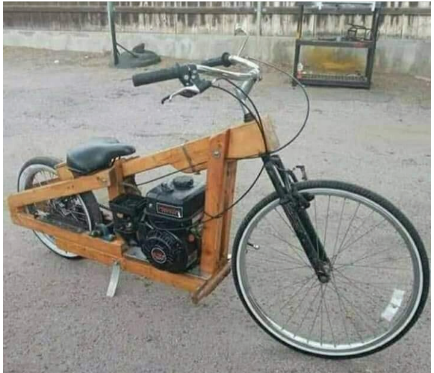
Figura 1: Podemos chamar o que vemos na figura como motocicleta, porém, é feita com madeira, guidom de bicicleta, além de pneus de tipos diferentes. Fonte: https://www.technologicaldisobedience.com/2021/07/26/rikimbilis-2021 .
