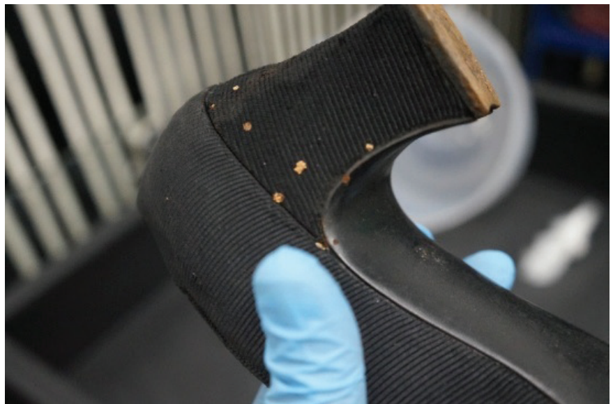
Figura 1: Calçado com salto de madeira perfurado por cupins. Fonte: Autora (2026).
