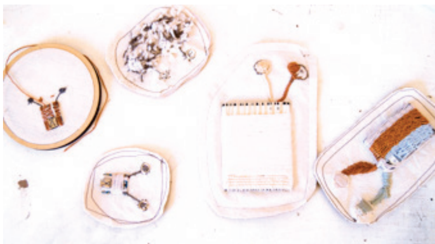
Figura 2 – Módulos (bateria, sensores, carregadores de bateria) do Kit de eletrônica têxtil Casulo. Fonte: acervo do Casulo
