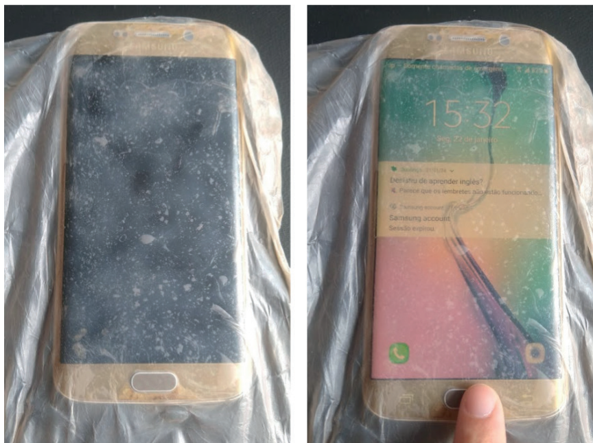
Figura 7 – Teste da película fina de CB sobre a tela de smartphone . Fonte: elaborado pelos autores, 2024.
