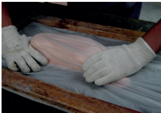
Figura 4 - Moldagem do EVA: Sucção do EVA no molde. Fonte: Adaptação de Brasil, 2014.
