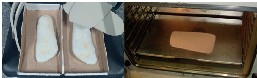
Figura 3 - Moldagem do EVA: molde positivo e EVA no forno. Fonte: Adaptação de Brasil, 2014.
