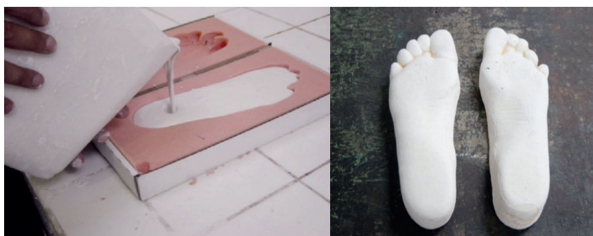
Figura 2 - Produção do molde positivo: preenchimento da espuma com gesso e molde positivo. Fonte: Brasil, 2014.
