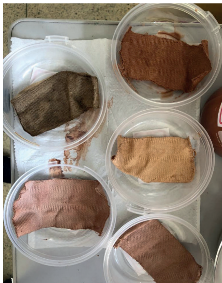
Figura 6 - Amostras secando após o tingimento. Fonte: elaborado pelas autoras, 2024.
