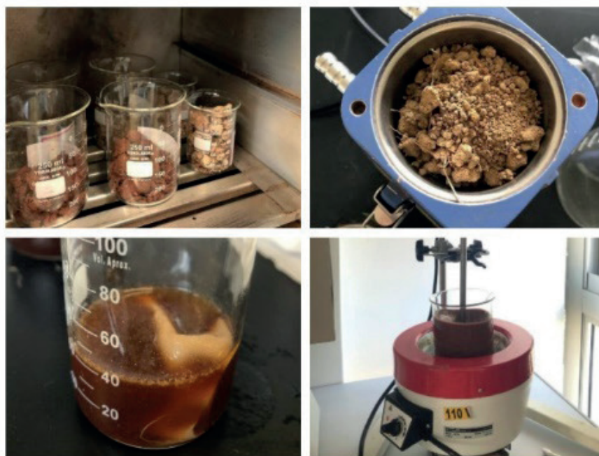
Figura 5 - Experimentos no laboratório (UEMG): (a) Secagem das terras na estufa; (b) Moagem das terras no moinho; (c) Banho de mordente da amostra; (d) Tingimento a quente em agitador mecânico. Fonte: elaborado pelas autoras, 2024.
